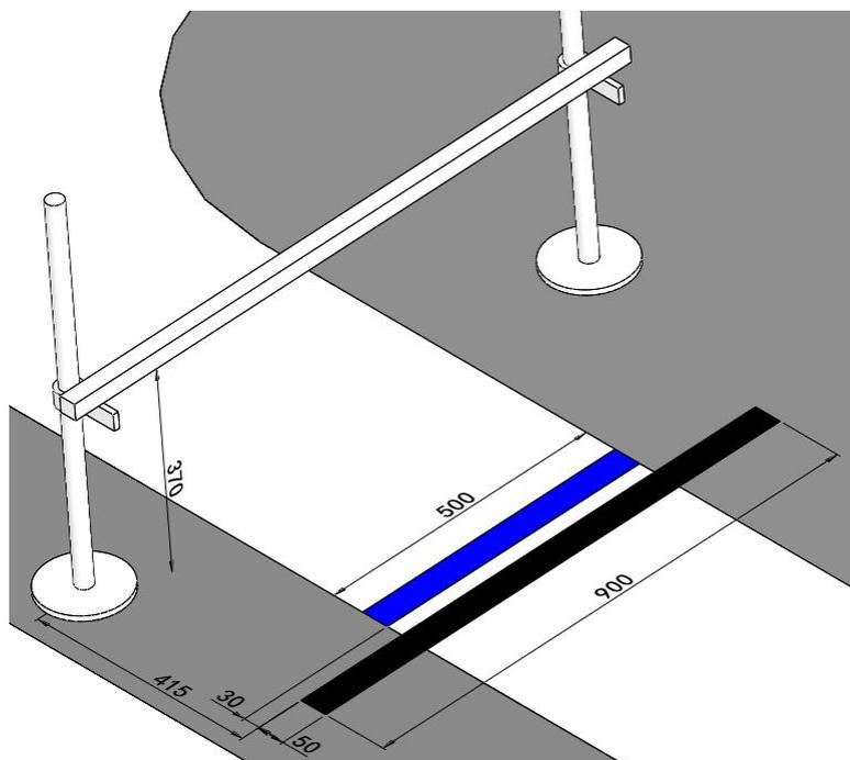
图 6 限高杆标识示意图（单位：mm）
