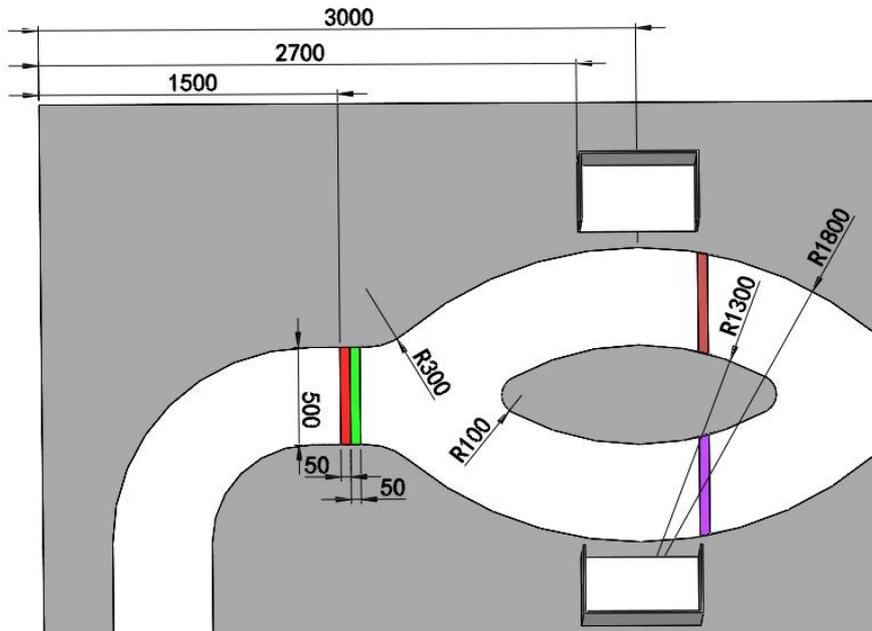
图 7 分岔路标识示意图（单位：mm）
