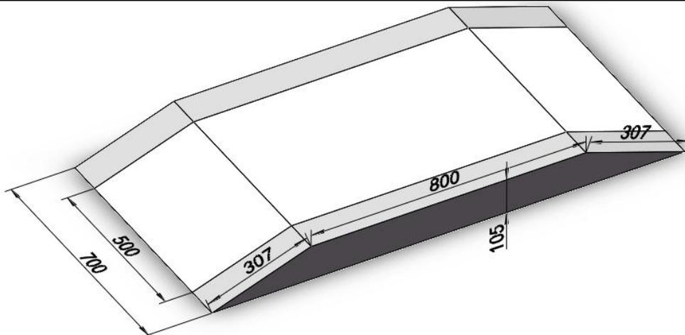
图 4 上下斜坡尺寸 (单位: mm)
