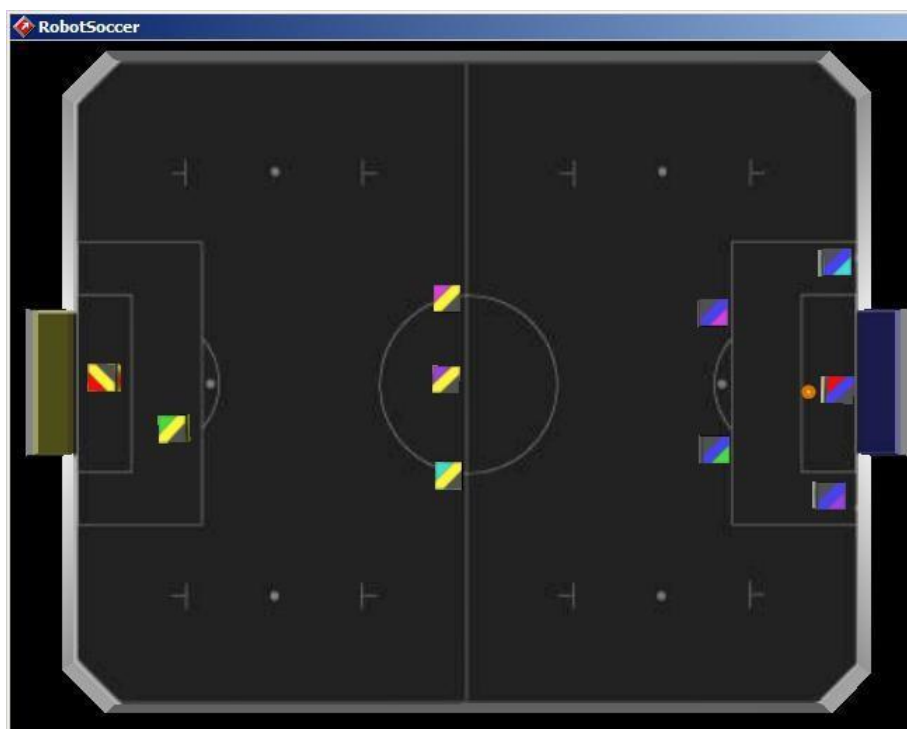
图 11: 门球时球和机器人的站位示意图
