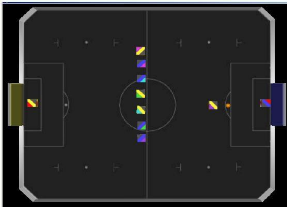
图 6 点球和点球机器人站位示意图
